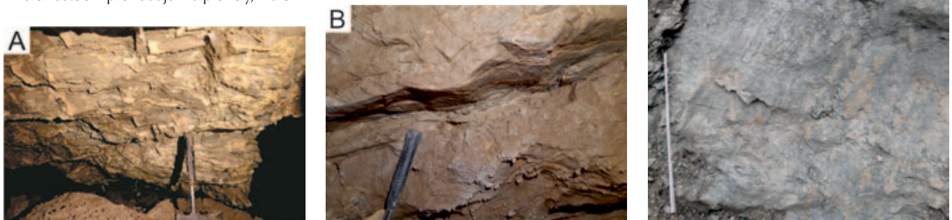
Obr. 9. Ilustrácia geologických pomerov jaskýň pod diaľnicou; pre podrobnejšiu charakteristiku obrázkov pozri text. A – vrstvenaté slienité vápence v jaskyni Hrboltová 1; B – tektonicky aktivovaná vrstvená plocha vyplnená tektonickým ílom v jaskyni Hrboltová 3; C – tektonicky reaktivovaná plocha v jaskyni Hrboltová 3 s indikátormi smeru tektonického transportu na SZS (čierna šípka) a tektonickými zrkadlami na čelách vrstiev s indikátormi pravostranného strihu (biela šípka); D – plocha sv.-jz. zlomu obnažená pri zemných prácach, v pozadí zárez viditeľný na obrázku E; E – zlomový styk kompaktnejších slienitých vápencov (vľavo) so silne tektonicky porušenými a zvetranými slienivcami (vpravo); F – ssz.-jv. zlom obnažený pri zemných prácach, na ktorom možno pozorovať sukcesiu indikátorov starších poklesových pohybov (čierna šípka) a mladších pravostranných pohybov (biela šípka). Foto: J. Littva Fig. 9. An illustration of the geological setting of the caves under the highway; see the text for a more detailed characterization of the figures. A – bedded marly limestone in the Hrboltová 1 Cave; B – tectonically activated bedding plane filled with fault gouge in the Hrboltová 3 Cave; C – tectonically activated bedding with indicators of the direction of tectonic transport towards WNW (black arrow) and slickensides on the bedding faces with indicators of dextral shear (white arrow) in the Hrboltová 3 Cave; D – the plane of the NE-SW fault exposed during the excavation work, roadcut visible in Figure E in the background; E – fault contact of more compact marly limestones (left) with strongly tectonically disturbed and weathered marlstones; F – the NNW-SSE fault exposed during the excavation work, on which the succession of indicators of older normal movement (black arrow) and younger dextral movement (white arrow) can be observed. Photo: J. Littva
